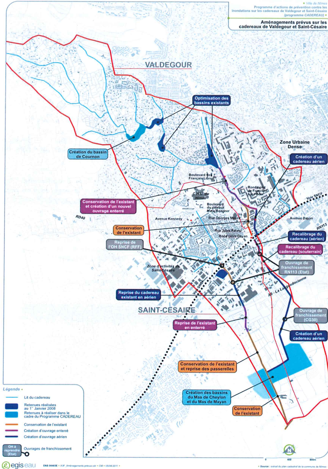
Figure 6 : Plan général des travaux
